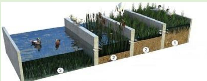
En la imagen superior, esquema de funcionamiento de un humedal artificial/filtro verde: 1-Flujo subsuperficial, 2- Flujo Superficial y 3-Laguna renaturalizada.
