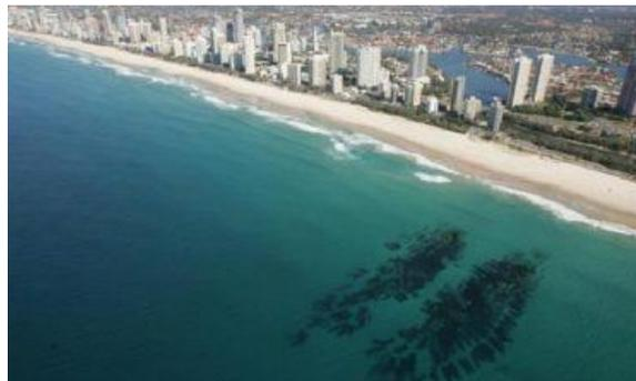
Ilustración 4-30: La conservación, restauración o creación artificial de ecosistemas costeros juegan un papel importante en la adaptación al cambio climático (en la imagen superior izquierda un sistema dunar y en la derecha dique de arrecife artificial de Narrowneck, Australia).
